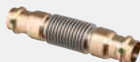
Compensador con SC-Contur - para compensación de dilatación en conducto para sótano o montante, conducto de conexión de planta en tecnología de calefacción y sanitaria - conexiones prensadas equipamiento Juntas tóricas de EPDM, conector de prensado de bronce o bronce silicio, fuelle de acero inoxidable modelo 2251
