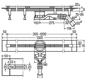
**Cuerpo base de canaleta de ducha Advantix Vario acortable de manera progresiva 70 mm (modelo para reforma)**
