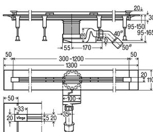
**Cuerpo base de canaleta de ducha Advantix Vario acortable de manera progresiva**
