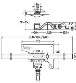
**Canaleta de ducha Advantix Cleviva con rejilla Advantix Visign C1**
